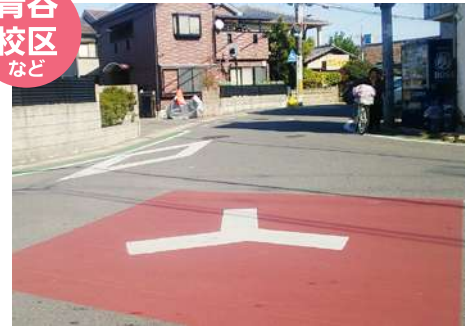
歩行者と車輛の通行量の多い危険度の高い交差点に目立つよう赤色(ベンガラ色)の路面表示
